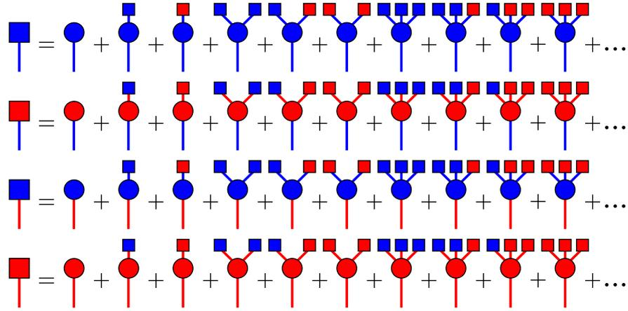
FIG. 3.2 – **Représentation schématique de la décomposition de  $H_{ij}(\mathbf{x}; \mathbf{T})$  en différentes contributions** pour  $M = 2$ . Les boîtes correspondent à des composantes dont la distribution en taille est donnée par  $H_{ij}(\mathbf{x}; \mathbf{T})$  et les cercles aux noeuds rejoints par un lien occupé. La couleur des boîtes correspond à la nature du premier noeud atteint ( $j$ ) et la couleur du lien à celle du noeud d'où nous sommes partis ( $i$ ).
