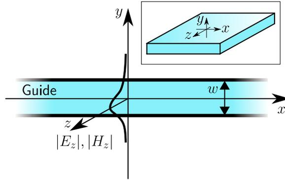
**Fig. E.1** Représentation de la section du guide d'onde plan et de l'amplitude du champ. Il s'agit d'une coupe sur le plan  $OxOy$  de la plaque diélectrique infinie apparaissant dans le coin supérieur droit de la Fig.
